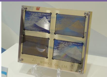
超精密平面研削盤を利用して微細切断加工した
